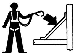
平台上的人员必须佩带安全带或使用符合政府规章的安全设施。将系索系在平台的锚上。
