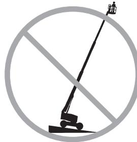
请勿把倾斜警报器当成水平指示器。只有机器严重倾斜时，平台上的倾斜警报器才会鸣响。
