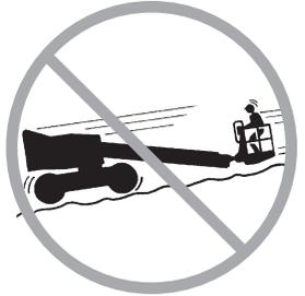
根据地面状况、拥塞程度、坡度、人员位置和可能引起碰撞的任何其它因素，限制行进速度。
