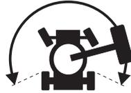
要进行驱动，将驱动启用开关扳向任一侧，缓慢移动驱动控制手柄，使其偏离中心位置。
