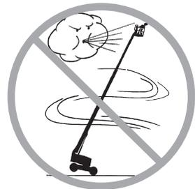
不要在风速可能超过 **12.5 m/s** 时升起臂杆。如果臂杆升起后风速超过 **12.5 m/s**，应降低臂杆并且不要继续操作机器。
